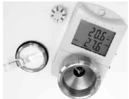
HM023 - sada 5 náplní na jedno použitie so štandardom vlhkosti 10% s piatimi aplikačnými poduškami
