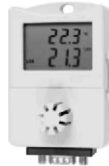
Teplomer - vlhkomer S3541 s ďalšími vstupmi 0÷5V
