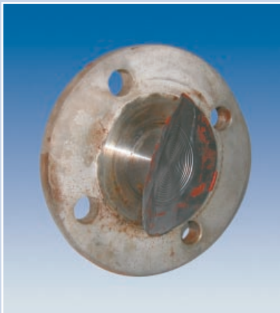
Typické poškození svaru tantalové membrány
