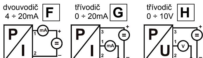
**Přiřazení vývodů:** platí pro konektor DIN 43650
