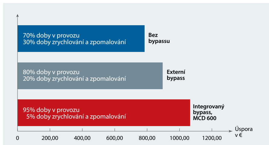
Úspora nákladů při použití bypassu. Je vidět prospěšný efekt delší doby běhu a kratší doby zrychlování a zpomalování.
