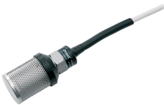
**Kapacitní hladinový snímač CLS-23S** je přímou náhradou snímače CLS-18S. Je konstruován jako spolehlivé a přitom levné řešení pro detekci výšky hladiny vody ve vrtech, studních, jímkách, nádržích apod. Snímač nemá nastavovací prvky, po instalaci a elektrickém připojení je ihned připraven k provozu. Připojení je dvouvodičové, přímo do elektrického obvodu s relé nebo na binární vstup řídicího systému.
