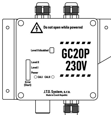
Úkolem detektora je včasné vyslání signálu o vznikající potenciálne výbušné atmosfére. Pro svou činnost používá neselektivní žhavené polovodičové čidlo, které reaguje na přítomnost široké řady hořlavých plynů nebo par. Kalibrací pomocí požadované konkrétní hlídané látky se dosahuje přesného nastavení pro jednotlivé aplikace. Detektor GC20P-230V je možné nastavit na různé látky především uhlovodíkového charakteru jako např. vodík, metan, propan, butan, alkoholy, aceton apod.
