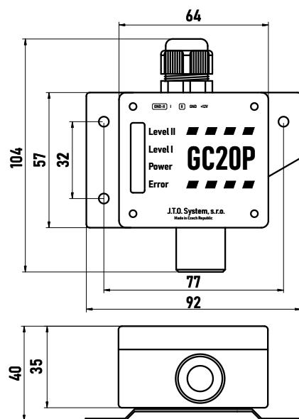
Úkolem detektora je včasné vyslání signálu o vznikající potenciálnej výbušnej atmosfére. Pro svou činnost používá neselektívne žhavené polovodičové čidlo, ktoré reaguje na prítomnosť široké řady hořlavých plynov nebo par. Kalibráciu pomocí požadované konkrétní hľadané látky se dosahuje přesného nastavení pro jednotlivé aplikace. Detektor GC20PN je možné nastavit na různé látky především uhlovodíkového charakteru jako např. vodík, metan, propan, butan, alkoholy, aceton apod.
