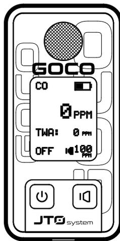
Detektor GOCO je přístroj určený ke kontrole přítomnosti oxidu uhelnatého v ovzduší v normálním prostředí. Jeho hlavními přednostmi jsou snadná obsluha, jednoduché použití, malé rozměry a dobrá mechanická odolnost. Přístroj umožňuje nastavit úroveň koncentrace, jejíž překročení je indikováno pomocí nepřerušovaného pískotu.
