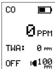
Na hlavní obrazovce nalezneme informaci o aktuální hodnotě koncentrace oxidu uhelnatého. Dále je zde informace TWA o průměrné hodnotě expozice oxidem uhličitým. Hodnota TWA se počítá jako aritmetický průměr aktuální hodnoty s maximální hodnotou periody 8 hodin.
