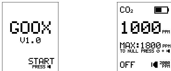
Následně se objeví hlavní obrazovka s informace o koncentraci plynu. Přístroj se vypíná delším přidržením tlačítka .
