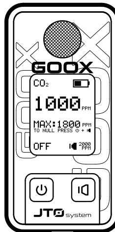
Detektor GOOX je přístroj určený k monitorování koncentrace oxidu uhličitého ( $\text{CO}_2$ ) v ovzduší. Jeho hlavními přednostmi jsou snadná obsluha, jednoduché použití, malé rozměry a dobrá mechanická odolnost. **Přístroj umožňuje nastavit úroveň koncentrace, jejíž překročení je indikováno pomocí nepřerušovaného písání.**
