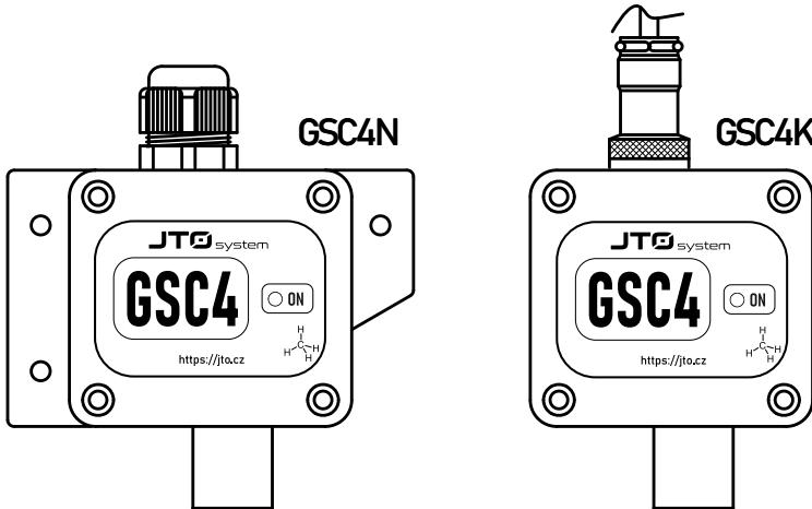
Úkolem snímače je kontinuální monitorování koncentrace hořlavých plynů nebo par v ovzduší. Pro svou činnost používá neselektivní katalytické čidlo, které reaguje na přítomnost široké řady hořlavých plynů nebo par. Kalibrací pomocí požadované konkrétní hlídané látky (např. vodík, metan, propan, butan, alkoholy, aceton apod.) se dosahuje přesného nastavení pro jednotlivé aplikace.
