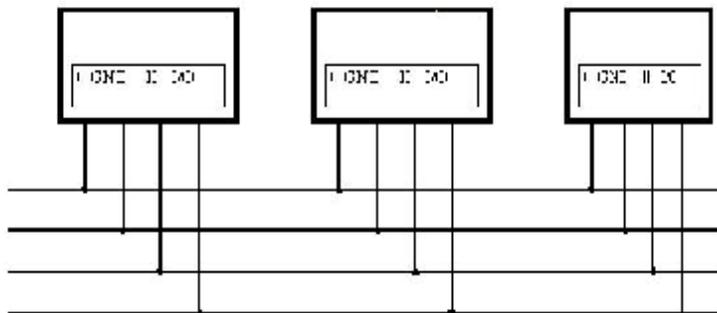
Pri paralelnom režime sú detektory zapojované na zbernicu, ktorá má použité signálne vodiče podľa konkrétnej aplikácie. Na obrázku je napríklad znázornený systém s 3 detektory zabezpečujúci detekciu dvoch úrovní koncentrácie plynu. Každý z detektorov je napojený na zodpovedajúce signály zbernice. Dva vodiče zaisťujú napájanie a po dvoch zostávajúcich sa vracia signál z detektorov do zdroja k ovládaniu relé.
