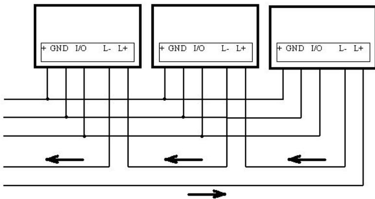
Pri tomto zapojení sa využíva možnosť spojiť detektory do sériovej slučky. Možno tak spínať napr. prúd v prúdovej slučke riadiaceho systému, kedy pri poruche na ktoromkoľvek detektore dôjde k prerušeniu slučky. Podobne je možné detektory zapojiť k zabezpečovacej ústredne a využiť možnosť pri poplachovom stave rozpojovať zabezpečovaciu slučku ústredne. Pri rozpojení slučky možno v riadiacom systéme určiť, ktorý detektor to spôsobil.
