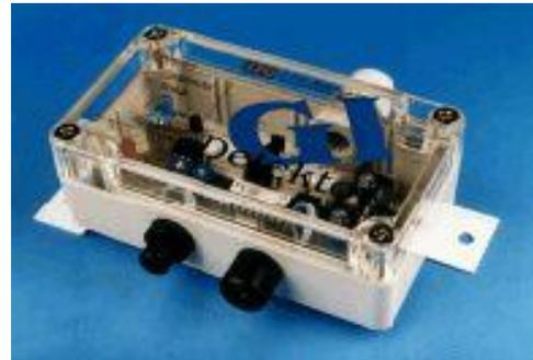
**Odvođený typ od detektoru GI30 s označením GI31 má zhodné parametre s ohľadom na detekciu horľavého plynu. GI31 má zvýšené krytie pre použitie v priestoroch, kde je vyšší stupeň nebezpečia výbuchu - pre prostredie ZONA 2.**
