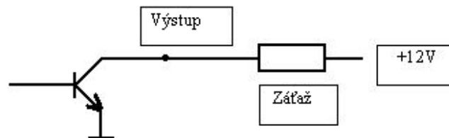
Výstupné svorky L- a L+ sú výstupy galvanicky oddeleného spínacieho tranzistoru. Tento spínač je pri správnej činnosti zopnutý, pri chybe na senzore alebo prekročení nastavenej úrovne II. je rozopnutý. Na funkciu tohoto výstupu pri prekročení koncentrácie II. úrovne nemajú vplyv prepojky M a D. Spínací tranzistor je galvanicky oddelený a je možné sériovo radiť viacej výstupov od ďalších detektorov. Pri zapojovaní výstupu je potrebné dbať na polaritu signálu.
