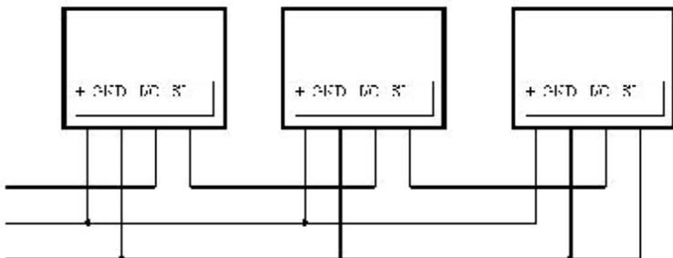
Potrebná súčasť tohoto zapojenia je vyhodnocovací systém, do ktorého prichádzajú dáta v sériovom tvare. Jednotlivé detektory sú zapojené do sériovej zbernice. Prvý z detektorov musí mať vstup pripojený na GND. Výstup z detektoru je potom vždy zapojený do vstupu nasledujúceho. Vyhodnocovací systém rozpozná stav jednotlivých detektorov.
