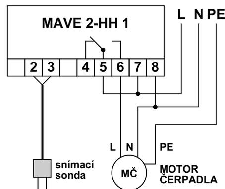
*Příklad zapojení snímače pro ochranu čerpadla proti chodu bez vody*
