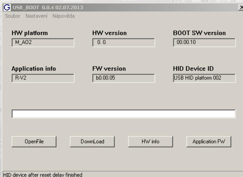
Podmínkou pro práci s aplikací USB\_BOOT je vložení jumperu J6 (povolení zápisu konfiguračních hodnot). Na PC se spustí Host aplikace USB\_BOOT, pomocí tlačítka „OpenFile“ se vybere nový aplikační FW a pomocí tlačítka „DownLoad“ se odstartuje obměna FW, která už je řízena automaticky PC a zařízením.
