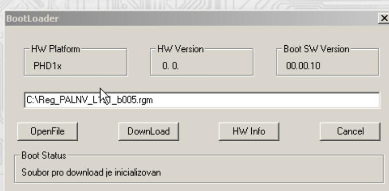
Podmínkou pro práci s aplikací je vložení jumperu J6 (povolení zápisu konfiguračních hodnot).
