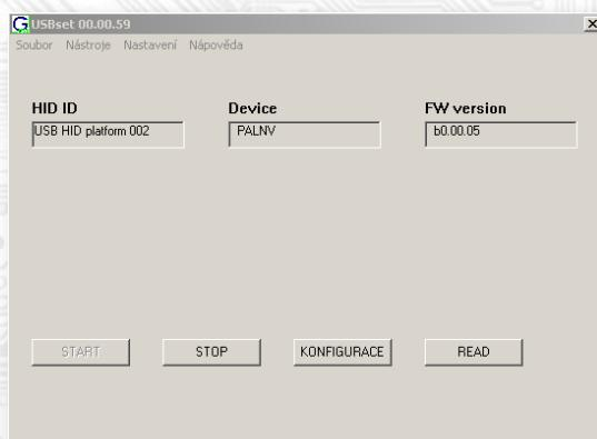
Kliknutím na tlačítko "READ" se otevře okno s aktuálními vstupními hodnotami.
